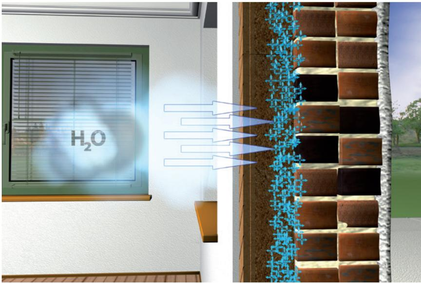
Durch die Kombinationsdämmplatte weich/hart, wird spürbar eine kapillar- und atmungsaktive Eigenschaft entwickelt, die für den Feuchtetransport zuständig ist.
