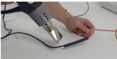
Schrumpfschlauch mittig über Pressverbindung ziehen und mit Heißluftföhn schrumpfen.
