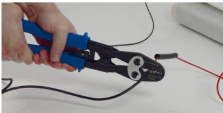
Universalverbinder mittig mit Presszange für Quetschverbinder nach DIN 46341-1, Forma A verpressen (z. B. Presswerkzeug Klauke K25).
